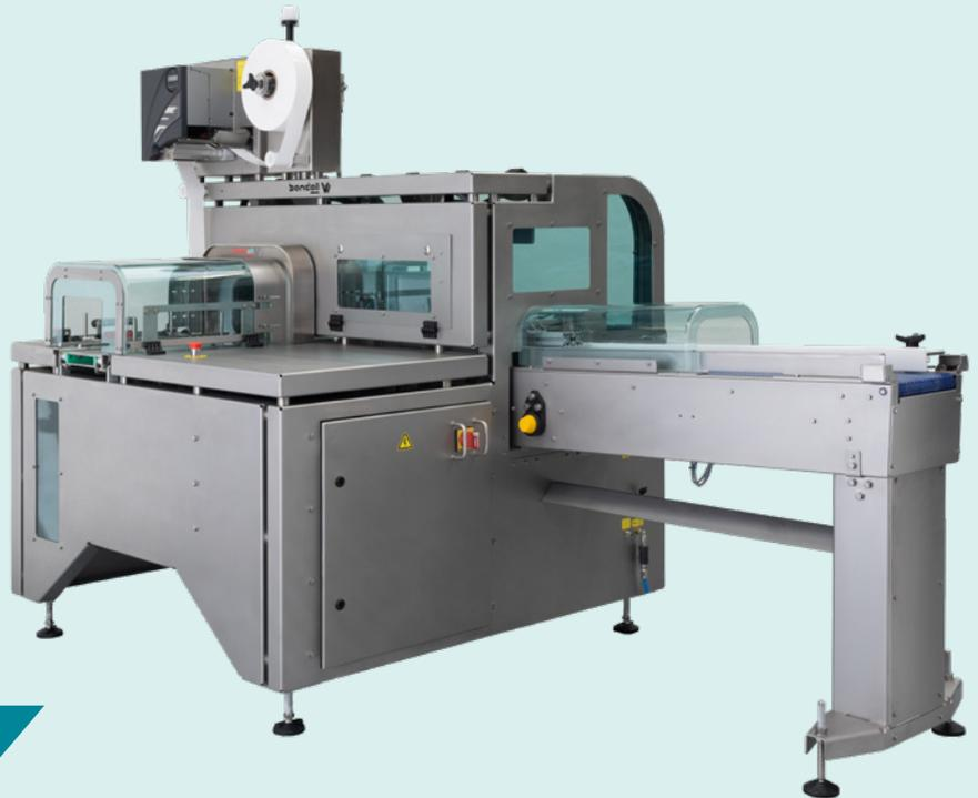
Un ejemplo de máquina de apilado y empaquetado totalmente automática. Esta máquina empaqueta hasta 240 cajas (pequeñas) por minuto en esquina.
